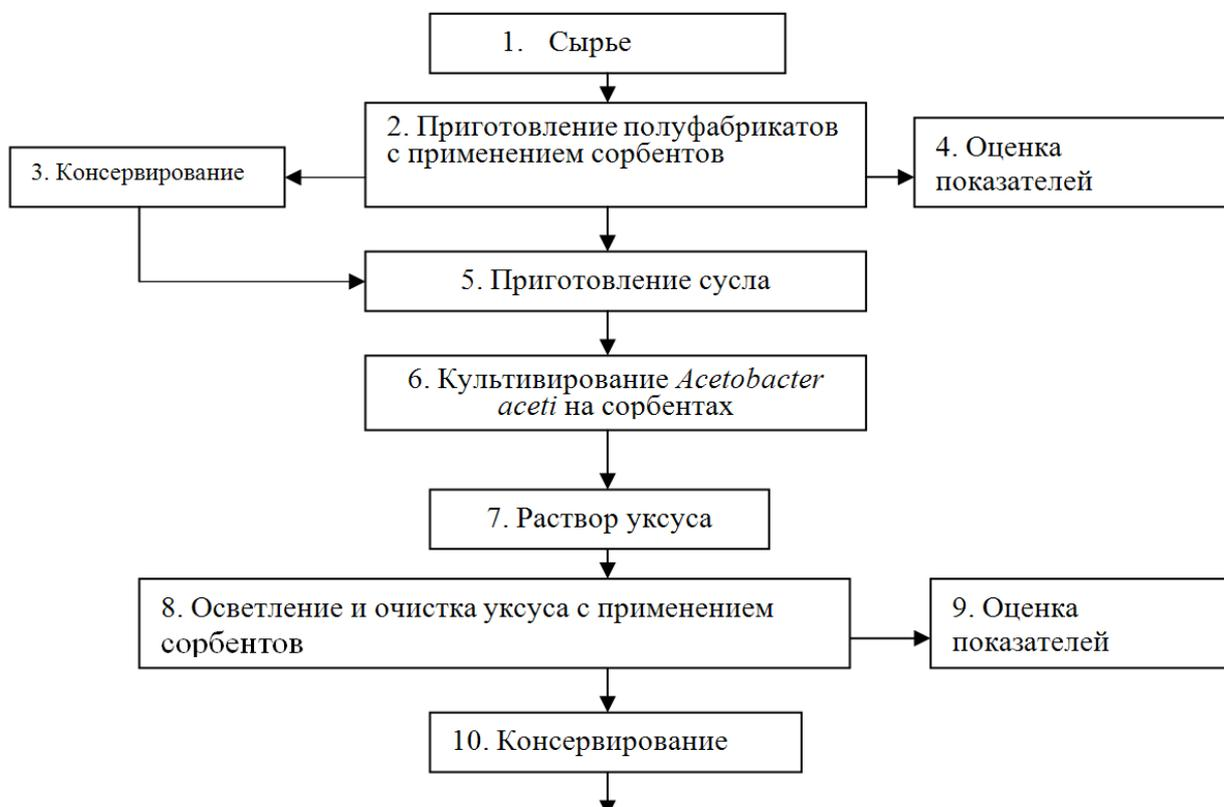
Рисунок 1 - Усовершенствованная технологическая схема получения пищевого уксуса из разного сырья на сорбентах: модуль 1 – стадии 1 - 5; модуль 2 – стадии 6 - 7; модуль 3 – стадии 8 – 11
