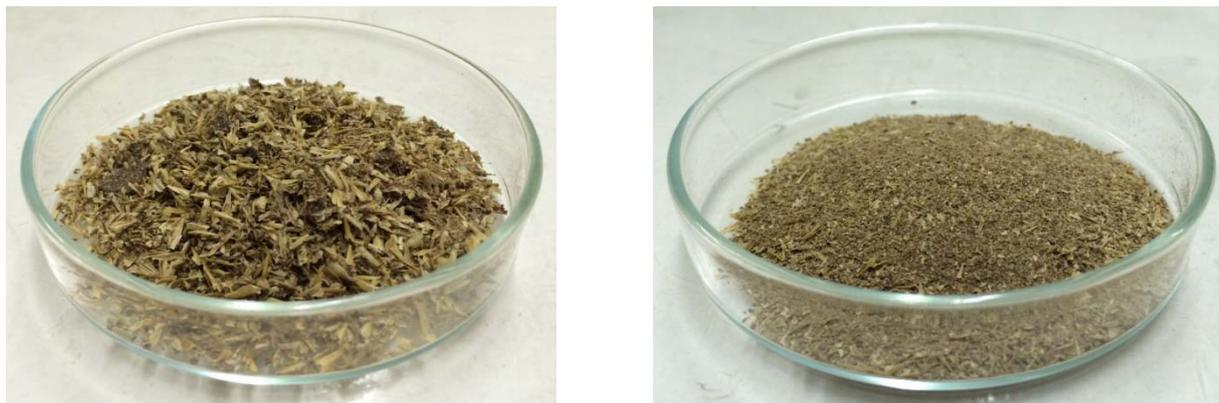
а) исходная пивная дробина ( $d = 5$  мм); б) измельченная пивная дробина ( $d = 1$  мм)
