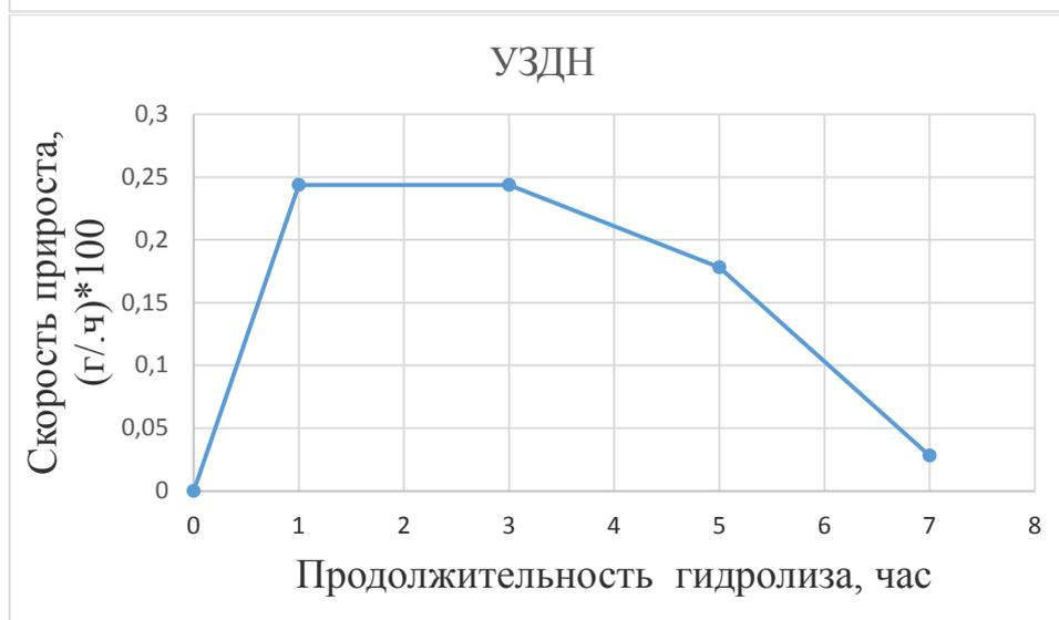
Рисунок 1 - Скорость прироста сахаров в зависимости от продолжительности гидролиза пивной дробины: А) фр. 5 мм, В) фр. 1 мм, С) фр.1 мм, УЗДН (22 кГц, 15 мин).
