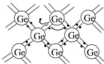
рис.41. Собственная проводимость германия
