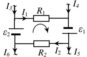
рис.34. Участок разветвленной электрической цепи
