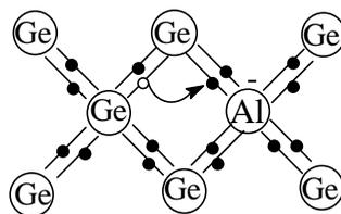
рис.43. Примесная дырочная проводимость
