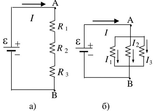
рис.31. Соединение сопротивлений  $R_1, R_2, R_3$ : а) последовательное; б) параллельное
