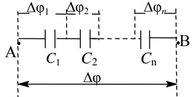
рис.29. Последовательное соединение конденсаторов
