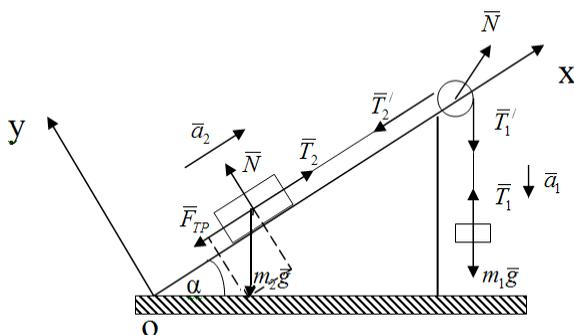
Укажем внешние силы, действующие на каждое из тел системы. Очевидно, гиря будет опускаться, а груз будет подниматься по наклонной плоскости. Рассмотрим движение гири. На гирю действует сила тяжести  $m_1 g$  и сила натяжения шнура  $\vec{T}_1$ . Поскольку гиря опускается ускоренно, то
