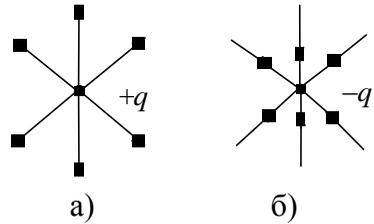
рис.23. Линии напряженности точечных зарядов: а) положительного; б) отрицательного
