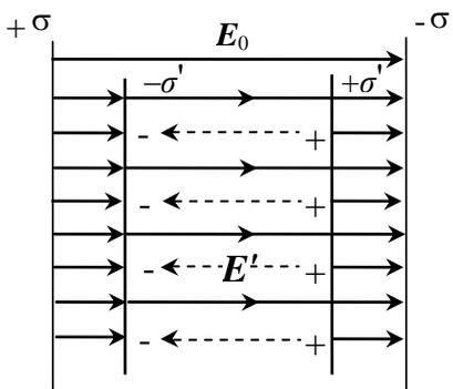
гранях пластинки диэлектрика появляются связанные заряды  $+\sigma'$  и  $-\sigma'$ , т.е. он поляризуется – приобретает дипольный момент. Вектор напряженности электрического поля внутри диэлектрика  $\vec{E}'$  направлен против  $\vec{E}_0$  внешнего поля.
