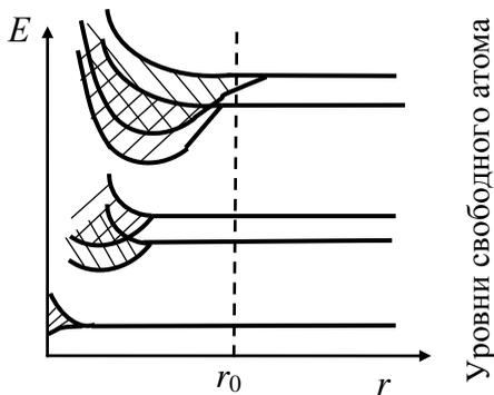
рис.44. Расщепление энергетических уровней в зависимости от расстояния  $r$  между атомами.  $r_0$  – расстояние между атомами в кристалле
