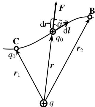
рис.27. К определению работы перемещения заряда в электростатическом поле
