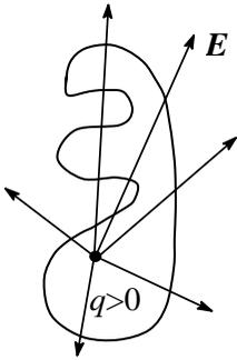
рис.26. Теорема Гаусса для замкнутой складчатой поверхности
