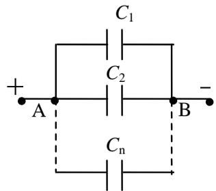
рис.28. Параллельное соединение конденсаторов
