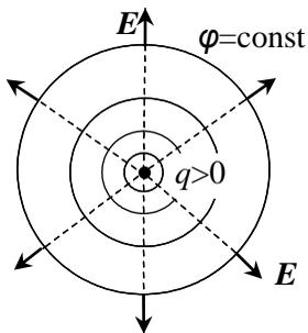
рис.27. Эквипотенциальные поверхности (сплошные линии) и силовые линии (пунктирные линии) поля точечного положительного заряда
