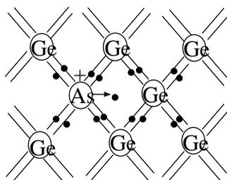
рис.42. Примесная электронная проводимость
