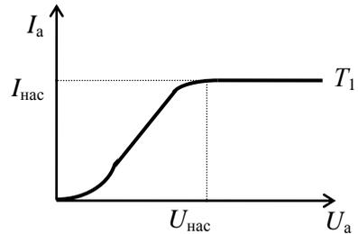
рис.40. Вольт-амперная характеристика диода
