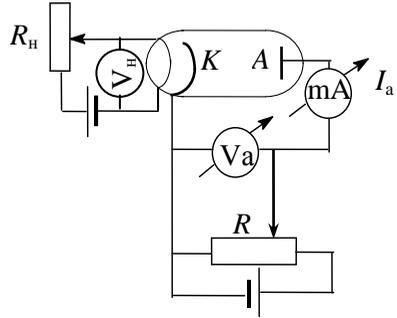
рис. 39. Схема включения вакуумного диода
