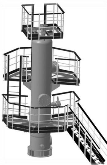
Рис. 1. Модель сепаратора предназначенного для очистки газа от капельной жидкости
