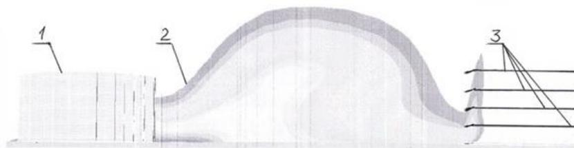
**Рис. 2.** Захватывание облака этилена паровой завесой:
