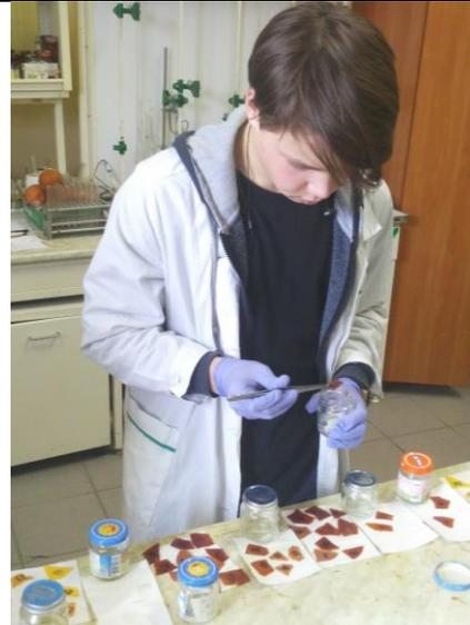
Рис.18. Взвешивание образцов на определение степени набухания
