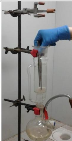
Рис.15. Извлечение образцов из Сокслета
