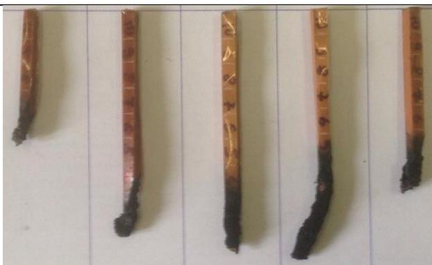
Рис.10. Образцы после испытания на горючесть
