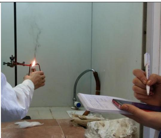
Рис.9. Проверка горючести брусков полимеров
