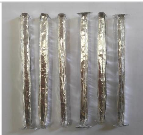
Рис.11. Подготовленные формы для заливки полимерной композиции
