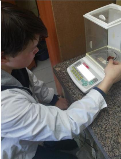
Рис.17. Подготовка образцов на определение степени набухания
