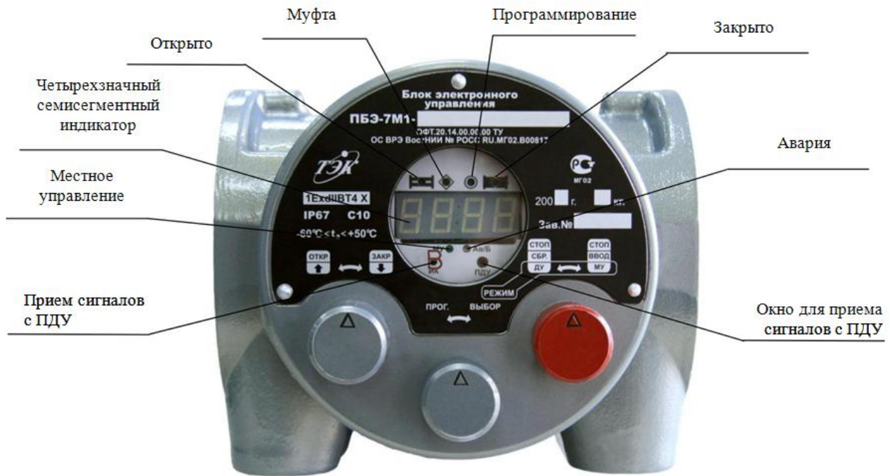
Рисунок 3 – Пост местного управления
