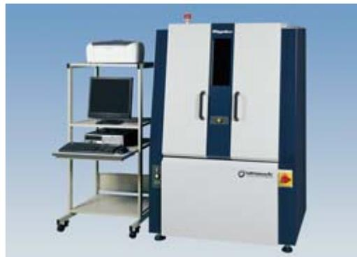
Революционным шагом в развитии аппаратных возможностей современных дифрактометров стало внедрение методов SAXS, малоуглового рентгеновского рассеивания, и in-plane, анализа в плоскости, в стандартную конфигурацию  $\theta/\theta$  дифрактометра. Теперь нет необходимости покупать два прибора или рисковать с синхротроном для решения такого рода задач.
