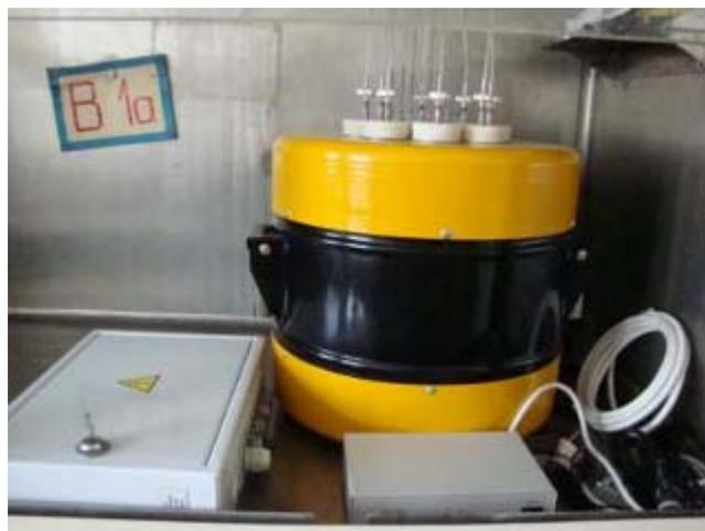
Работа ИВК основана на измерении давления газов и паров распада веществ в замкнутой реакционной камере первичного преобразователя в изотермическом режиме с регистрацией результатов измерений в виде таблиц, графиков с помощью персонального компьютера.
