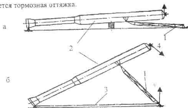
Рис.3.12. Схема подъема аппарата с применением опорной стойки: а, б – этапы подъема; 1 – опорная стойка; 2 – аппарат; 3 – тяга или полиспаст; 4 – тормозная оттяжка
