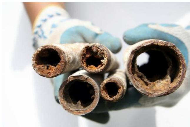
Рис. 10. Слой накипи в водопроводных трубах
