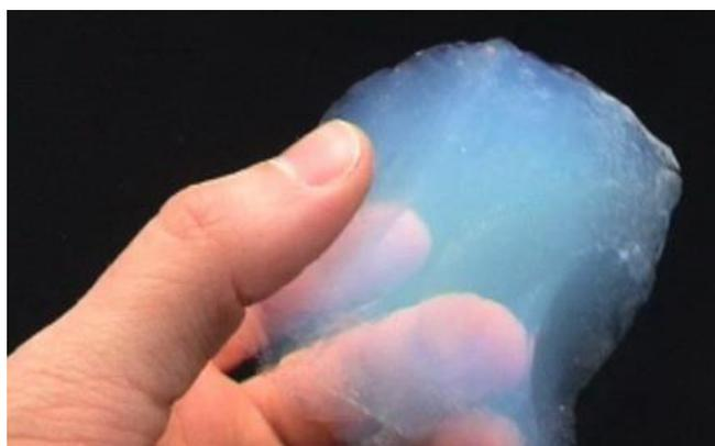
Рис. 7. Аэрогель – «твердый дым»
