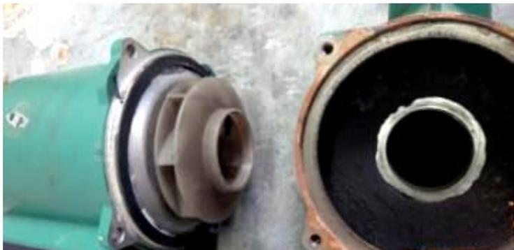
Рисунок 7. Замена прокладки в циркуляционном насосе
