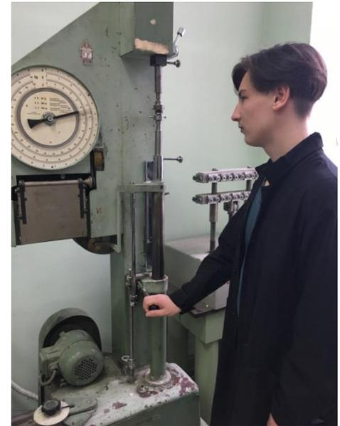
Рисунок 3. Проведение испытаний на разрывной машине типа РМИ-250 КНИТУ, лаб. Б-133.
