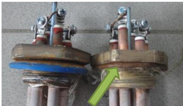
Рисунок 8. Замена прокладки в тене водогрейного котла
