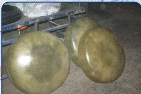
Обтекатели шахтных вентиляторов
