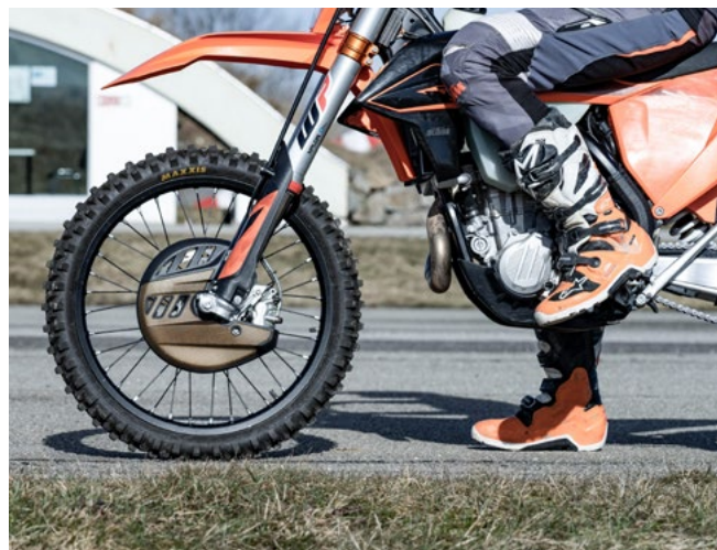
Тормозной кожух на базе терморепактивных и термопластичных биокмполитов
