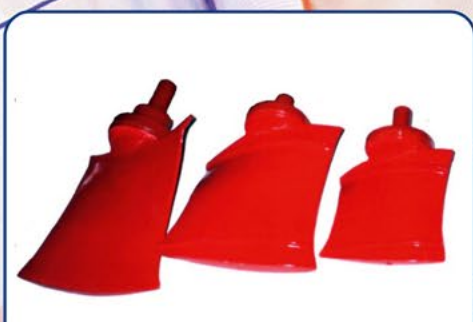
Лопатки шахтных вентиляторов
