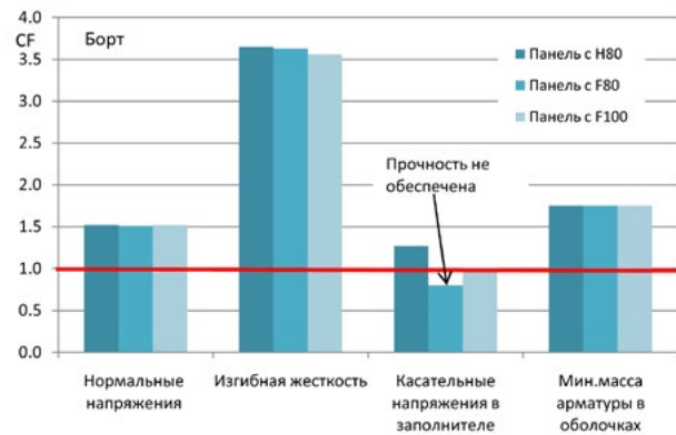
Рисунок 5. Результат расчетов пластины борта с использованием различных пенопластов
