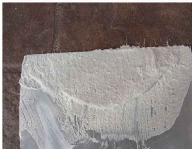
Фото 4. Армирующие рубленые базальтовые волокна в составе раствора
