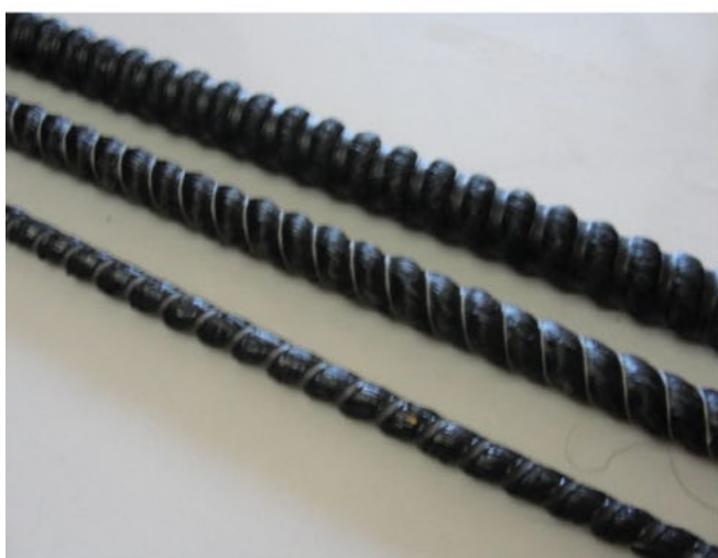
Фото 11. Образцы арматуры с вдавленным профилем в жгуты пропитанного ровинга
