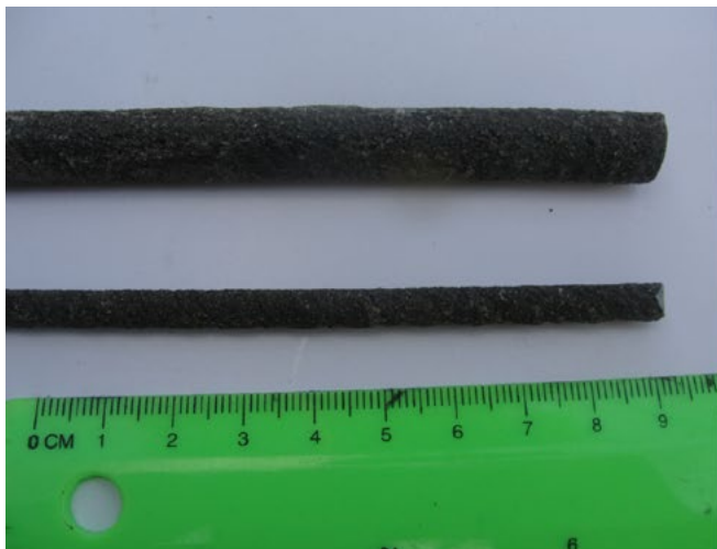
Фото 9. Образцы композитной арматуры — прутки покрытые отсевом крупного песка
