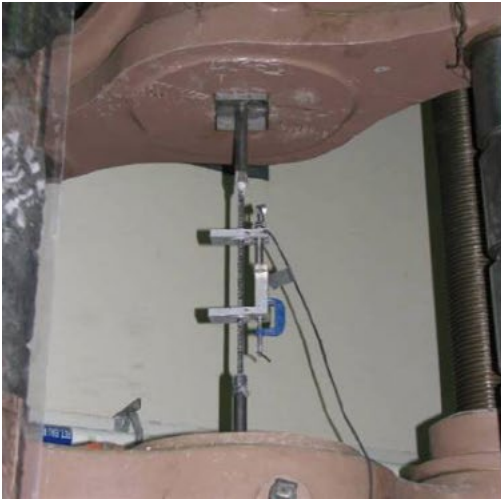
Фото 13. Испытания образца АБП на растяжение
