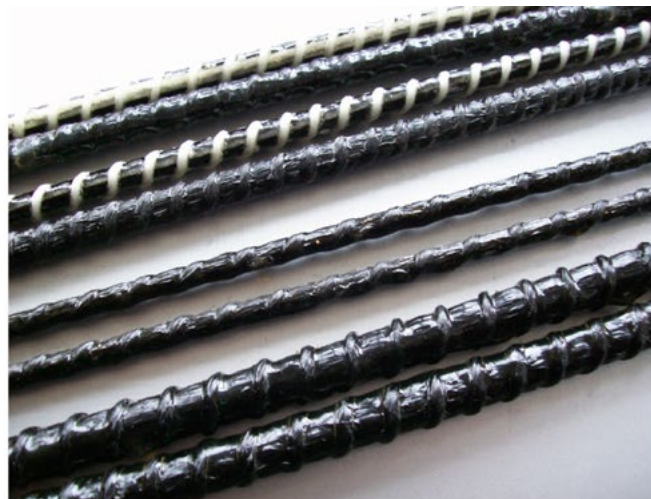
Фото 10. Образцы композитной арматуры БНВ с навивкой арматурного профиля
