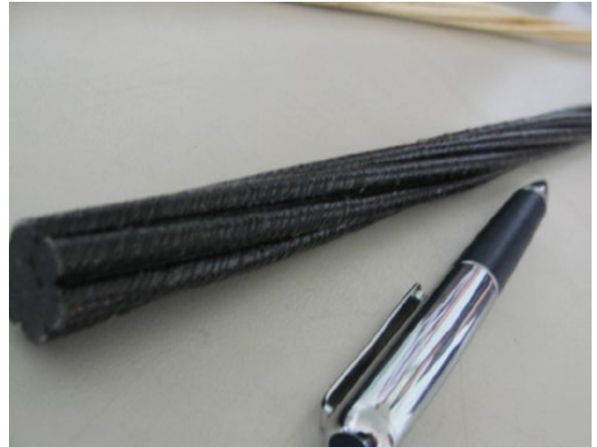
Фото 20. Композитный трос на основе ровингов БНВ для вантовых мостов
