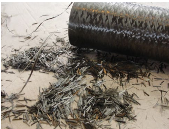
Фото 1. Базальтовое рубленое волокно (базальтовая фибра), диаметр элементарных волокон d = 15\text{--}17 микрон, длина 21 мм
