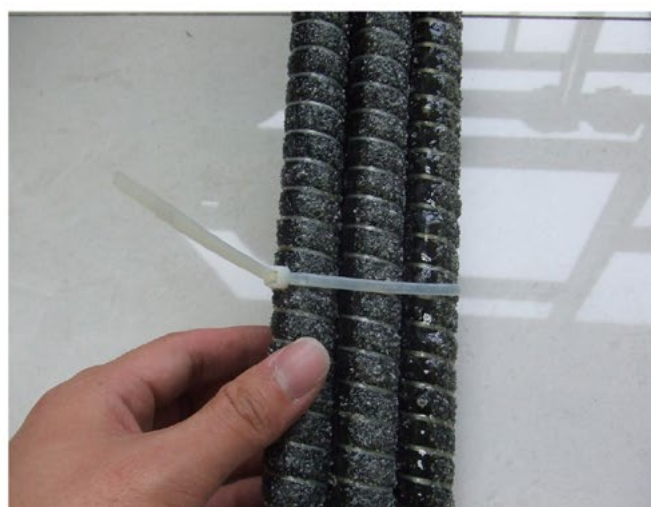
Фото 12. Образцы арматуры с вдавленным профилем и покрытием отсевом песка
