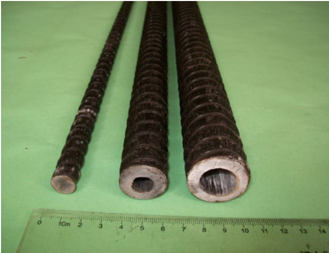
Фото 19. АКБ — полые анкеры для крепления тоннелей
