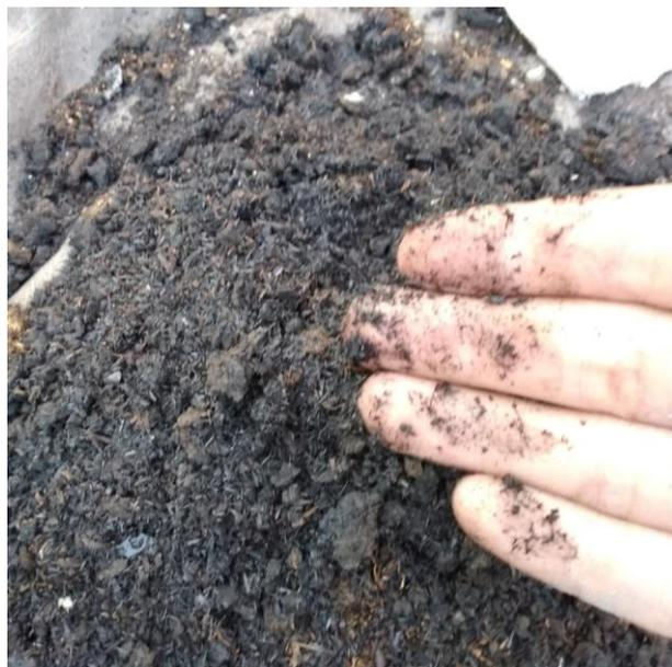
*Рисунок 4.6 – Зола после выгрузки из газификационной установки. После процесса газификации при температуре 500 °С*
