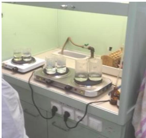
*Рисунок 4.13 – Наблюдение за процессом устранения мешающих факторов в пробе методом выпаривания*
