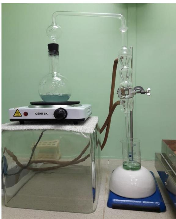
*Рисунок 4.18 – Установка и процесс определения азота в помёте*
