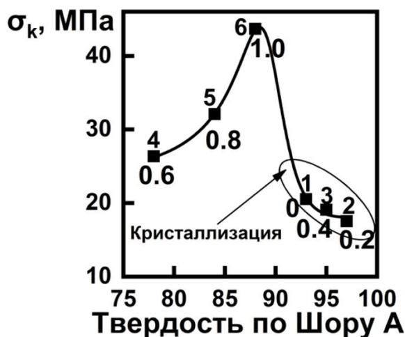
Рисунок 4.5 – Зависимость прочности образцов серии СПВ от твердости по Шору А. Над кривой – нумерация точек на рисунке соответствует номерам образцов серии СПВ. Под точками указано соответствующее молярное содержание МОСА в отверждающей смеси
