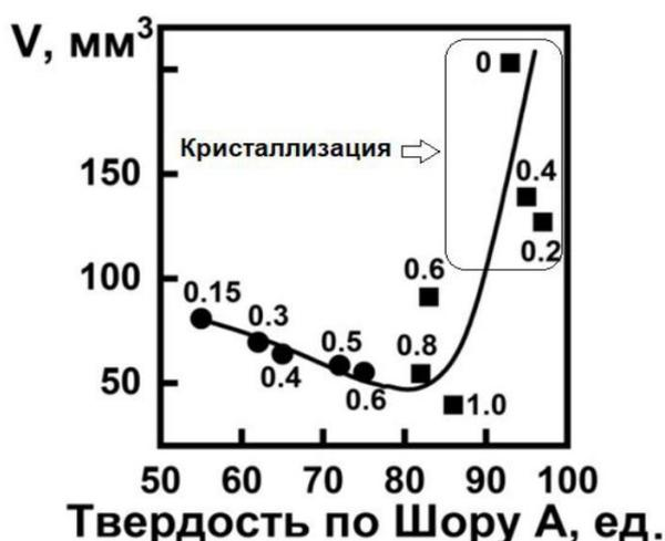
Рисунок 4.6 – Зависимость объемного износа образцов эластомеров от твердости по Шору А образцов серии СПВ (■) и образцов серии ПШБ (●). Рядом с точками указано соответствующее молярное содержание МОСА в отверждающей смеси
