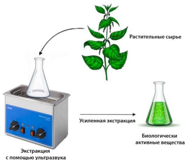
Рис. 1. Общая схема ультразвуковой экстракции
