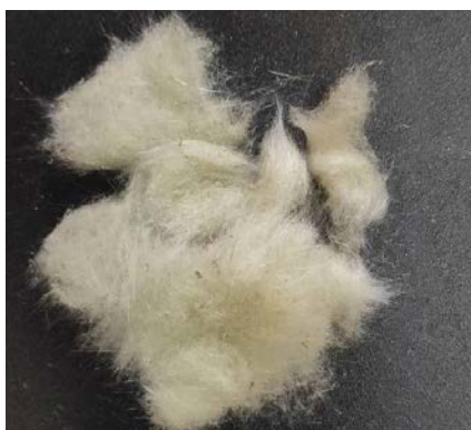
Рис. 2. Внешний вид базальтового волокна (диаметр волокон 4-12 мкм)
