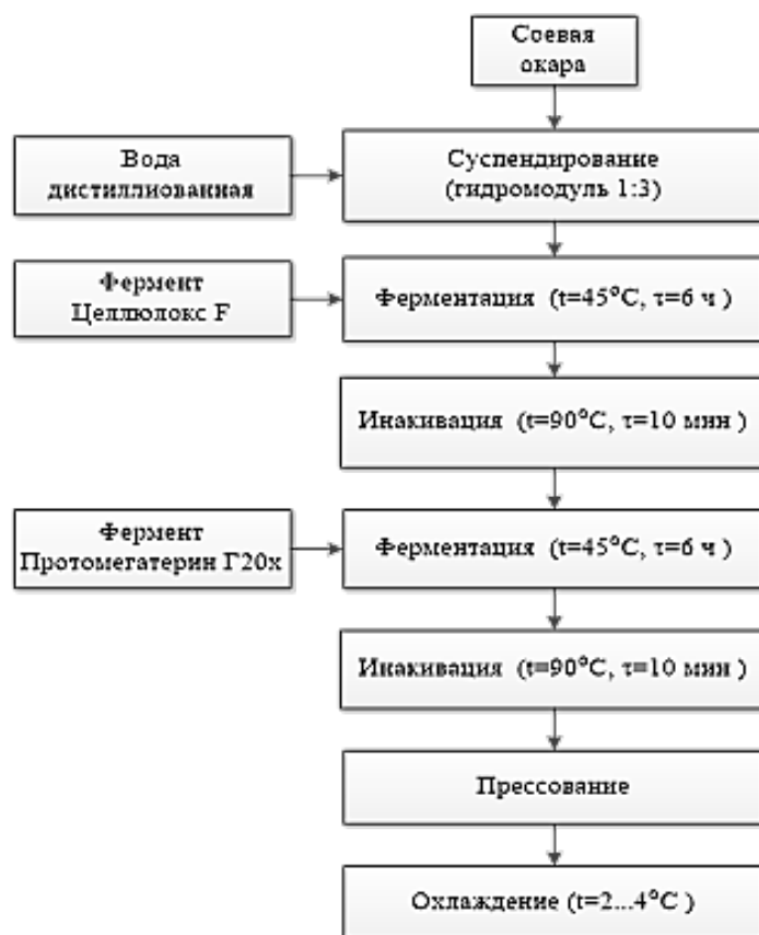
Рис. 1. Технологическая схема применения ферментных препаратов для обработки соевой окары [5]
