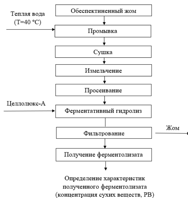
Рис. 2. Принципиальная схема ферментативного гидролиза обеспектиненного яблочного жома
