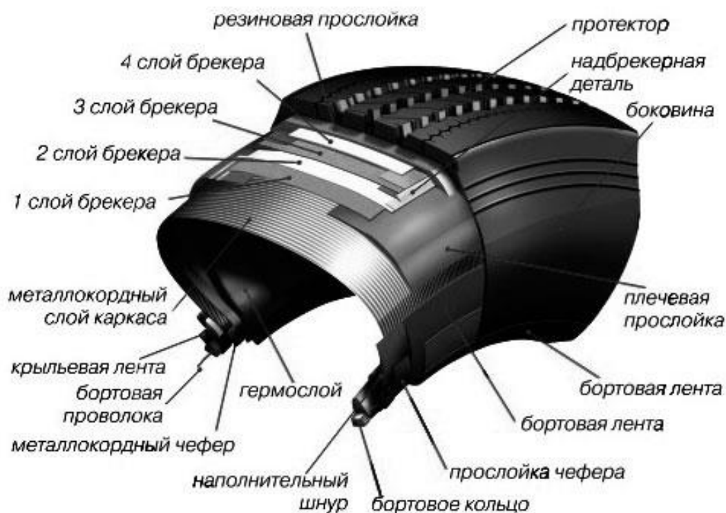
Рис. 4 – Схема автомобильной шины в разрезе
