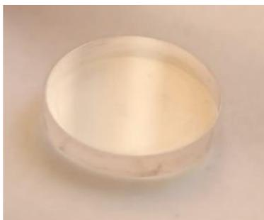
Рисунок 34 – Напыленная пленка комплекса Eu(III) на стекле KBr (б)
