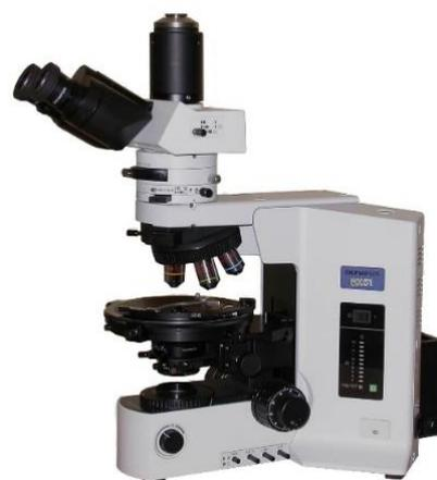
Рисунок 30 – Поляризационный оптический микроскоп Olympus BX51
