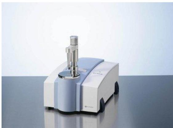
Рисунок 33 – ИК-спектрометр ALPHA-T S/N 102706 («Bruker»)
