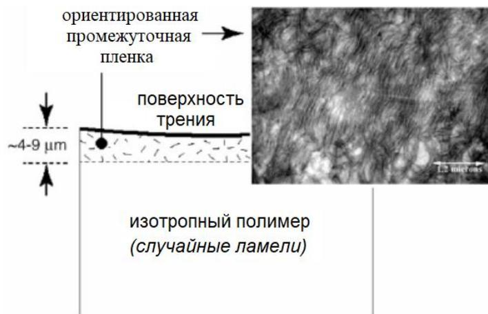
Рисунок 11 – Изношенный слой и микрофотография СЭМ [86]
