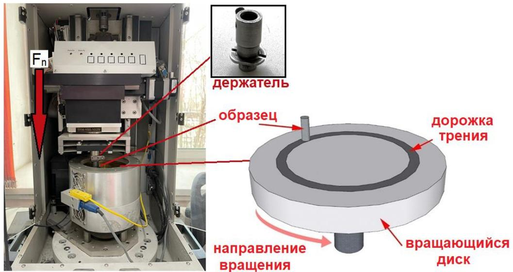
Рисунок 18 – Схема трения «палец-диск»
