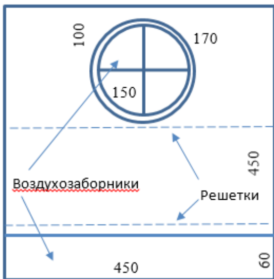
Рисунок 3 – Камера – вид спереди с открытой дверцей – две решетки для образцов; воздухозаборники – круглый сверху и прямоугольный снизу
