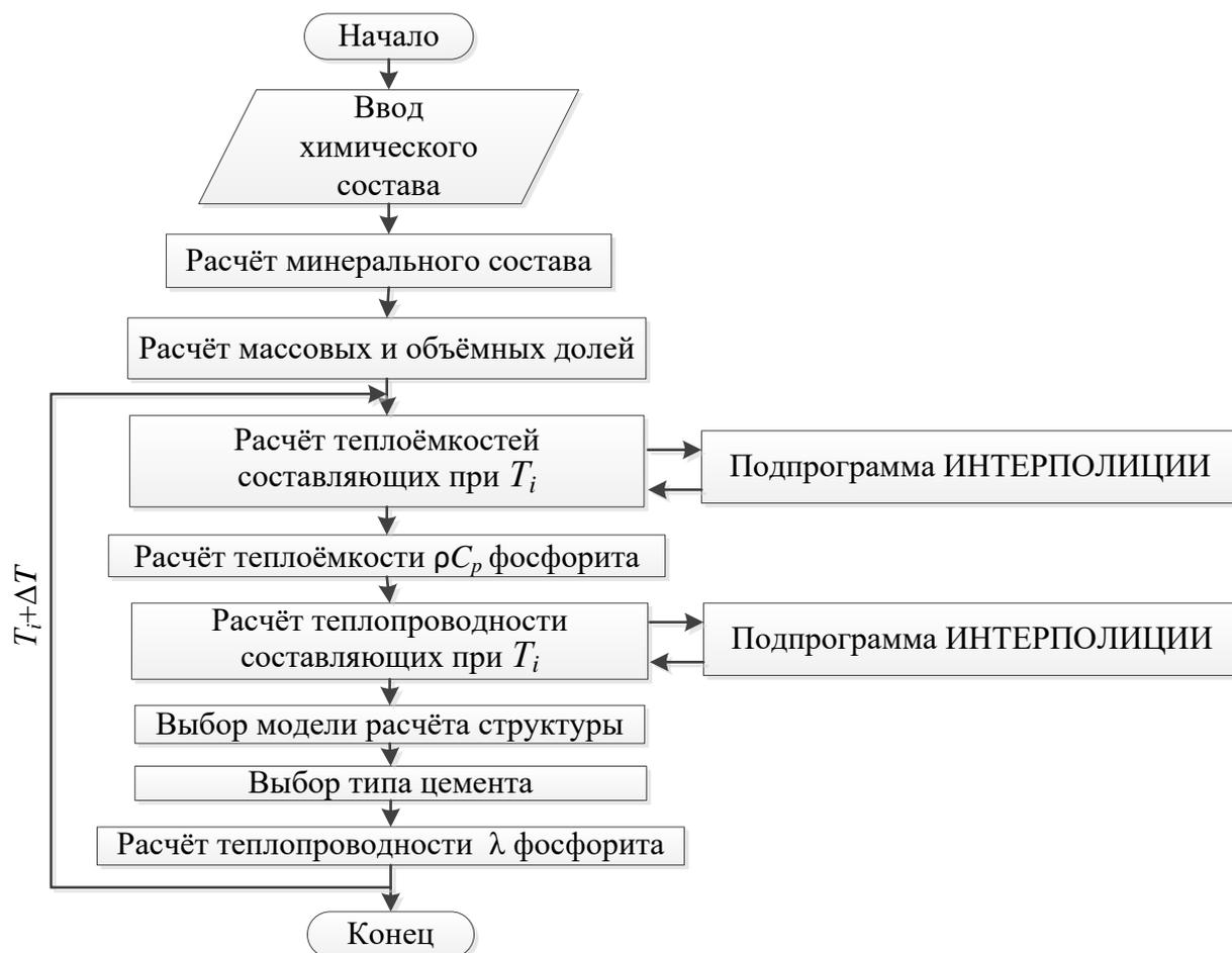
Рисунок 3.5.1 – Блок схема алгоритма расчета теплофизических свойств по структурной модели (построено автором)
