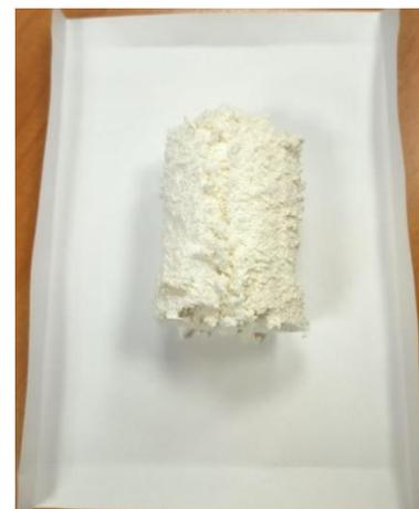
Рисунок 3.21 – СЭМ изображение и внешний вид смеси ПЭНД(75%)/СКЭПТ-50(25%), полученной в результате диспергирования при  $T=40\text{ }^{\circ}\text{C}$  и  $P=8\text{ МПа}$
