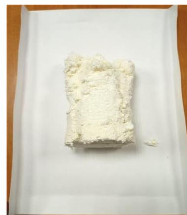
Рисунок 3.23 – СЭМ изображение и внешний вид смеси ПЭНД(75%)/СКЭПТ 50(25%), полученной в результате диспергирования при  $T=40\text{ }^{\circ}\text{C}$  и  $P=25\text{ МПа}$
