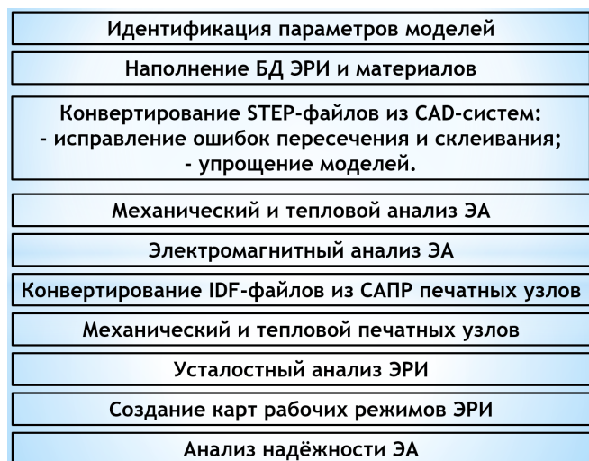
Рисунок 2.1 – Комплексный анализ надёжности электроники на основе сквозного моделирования физических процессов с помощью системы АСОНИКА
