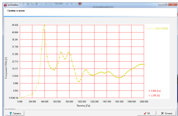
Рисунок 7.15 – Зависимость максимального суммарного ускорения от частоты гармонической вибрации (в точке МХ на рисунке 7.14)
