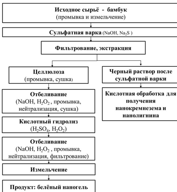
Рисунок 1 – Схема процесса получения наноцеллюлозы из бамбука
