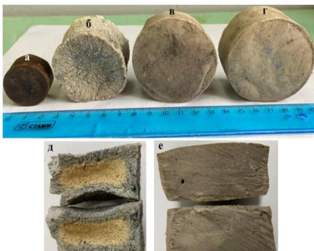
Рисунок 19 – Геометрические размеры ВНР до набухания (а) и после 120 суток экспозиции в дистиллированной воде (б, в, г, д, е) на основе смеси НК/Na-КМЦ/НЦ (% мас.), полученных: **б** – 50/50/0 методом твердофазного смешения; **в** – 50/50/0; **г** – 50/48/2 методом жидкофазного совмещения; **д** – поперечное сечение образца **б**; **е** – поперечное сечение образца **г**
