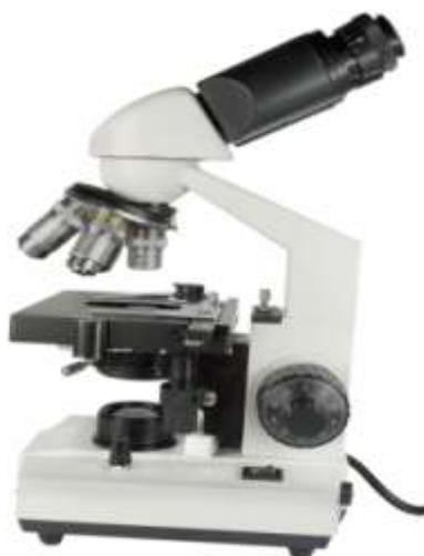
Рисунок 9 – Микроскоп бинокулярный серии XSP-104.
