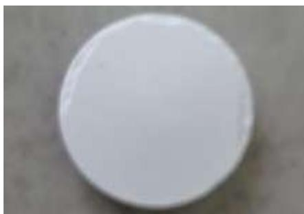
Рисунок 60 – Фотография керамического материала, полученного при температуре спекания 900°C, ув. x10.
