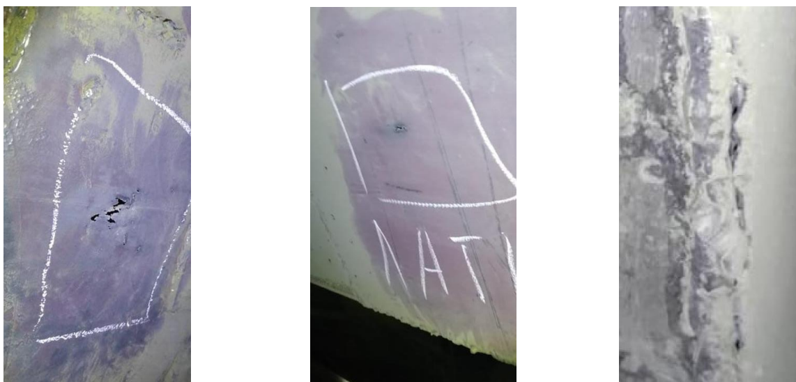
Рис. 3.1 – Образование дыр в циклонах
