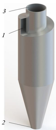
Рис. 1.22 – Трехмерная реальная модель циклона ЦН-15: 1 – входной патрубок для загрязненного катализатором газа; 2 – выход для частиц катализатора, которые улавлились в результате очистки; 3 – выход очищенного газа
