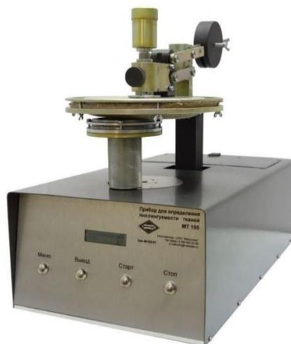
Рисунок 2.6 – Устройство для определения пиллингуемости тканей (типа ПМВ-4М) МТ 195
