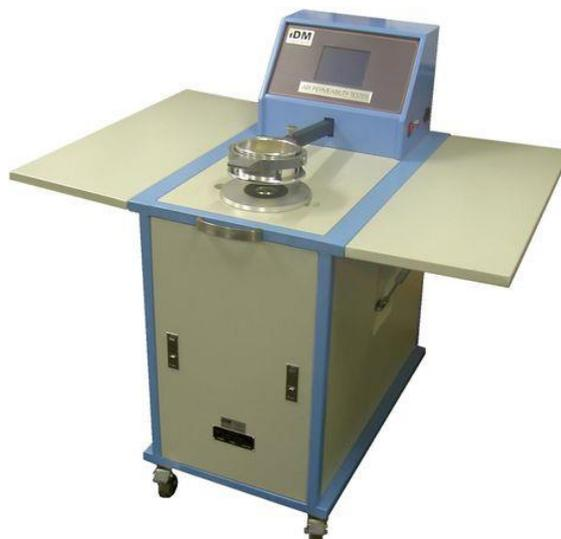
Рисунок 2.12 – Прибор для определения воздухопроницаемости материалов
