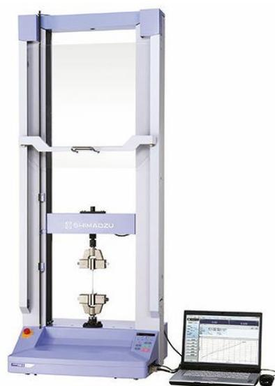
Рисунок 2.5 – Универсальная испытательная тест-машина Shimadzu серии AGS-X
