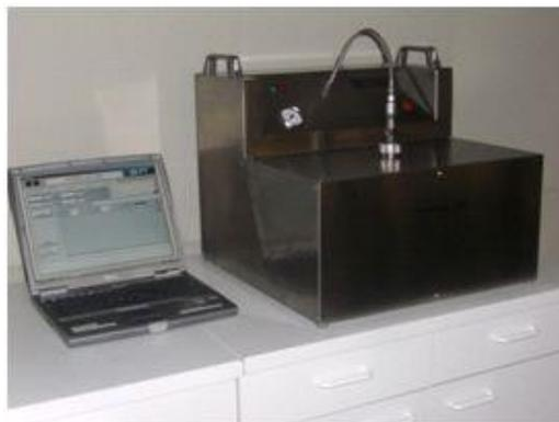
Рисунок 2.9 – Газожидкостной порометр POROLUX™100
