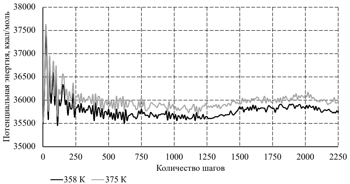
Рисунок 3.23 – Изменение потенциальной энергии моделируемой системы при одноосной деформации
