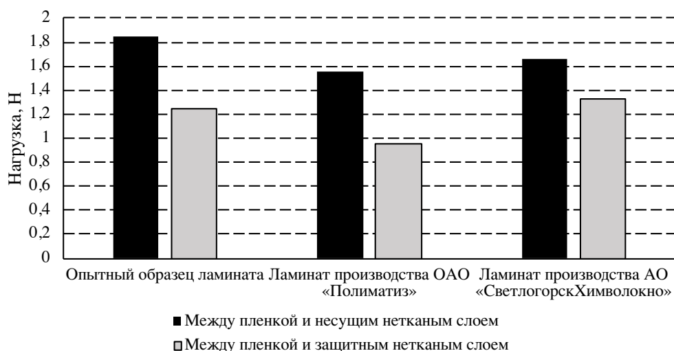
Рисунок 3.31 – Прочность сварного скрепления слоев образцов промышленных ламинатов и опытного образца
