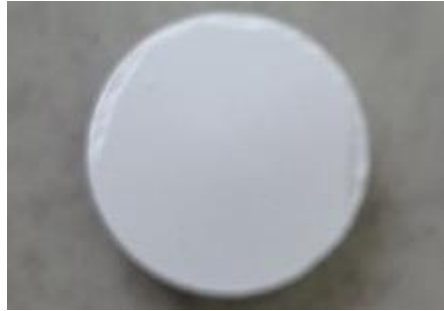
Рисунок 23 – Фотография керамического материала, полученного при температуре спекания 900°C, ув. x10.
