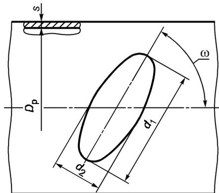
Рисунок А.13 — Отверстие для овалного штуцера, перпендикулярного к поверхности обечайки
