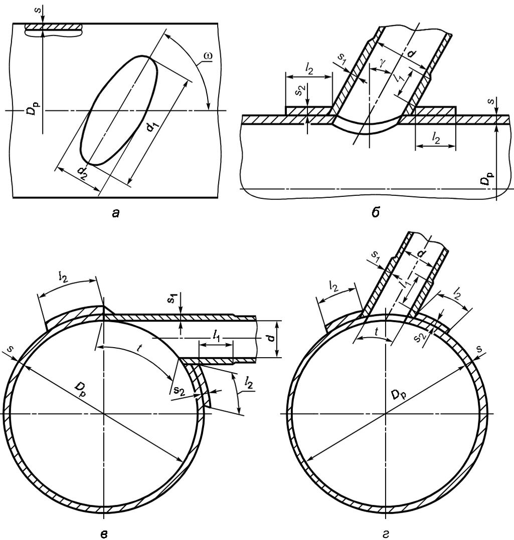
Рисунок А.11 — Наклонные штуцера на обечайке
