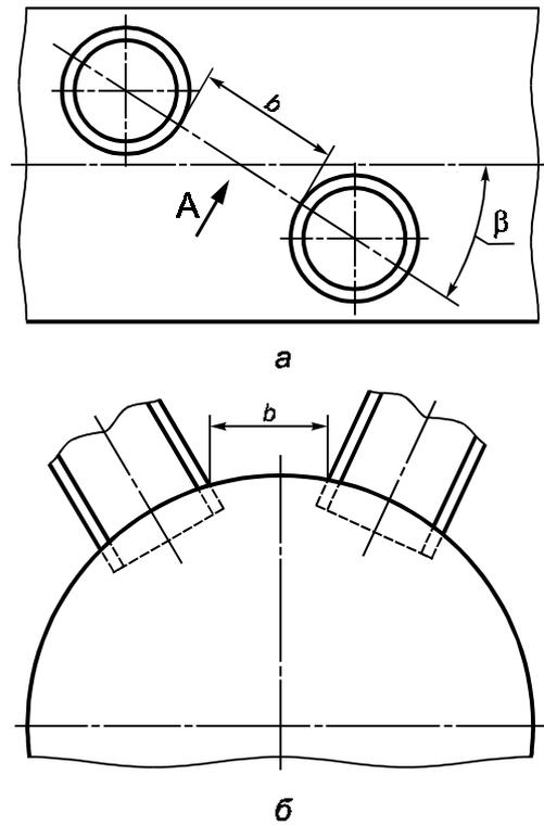
Рисунок А.3 — Общий случай расположения взаимодействующих отверстий
