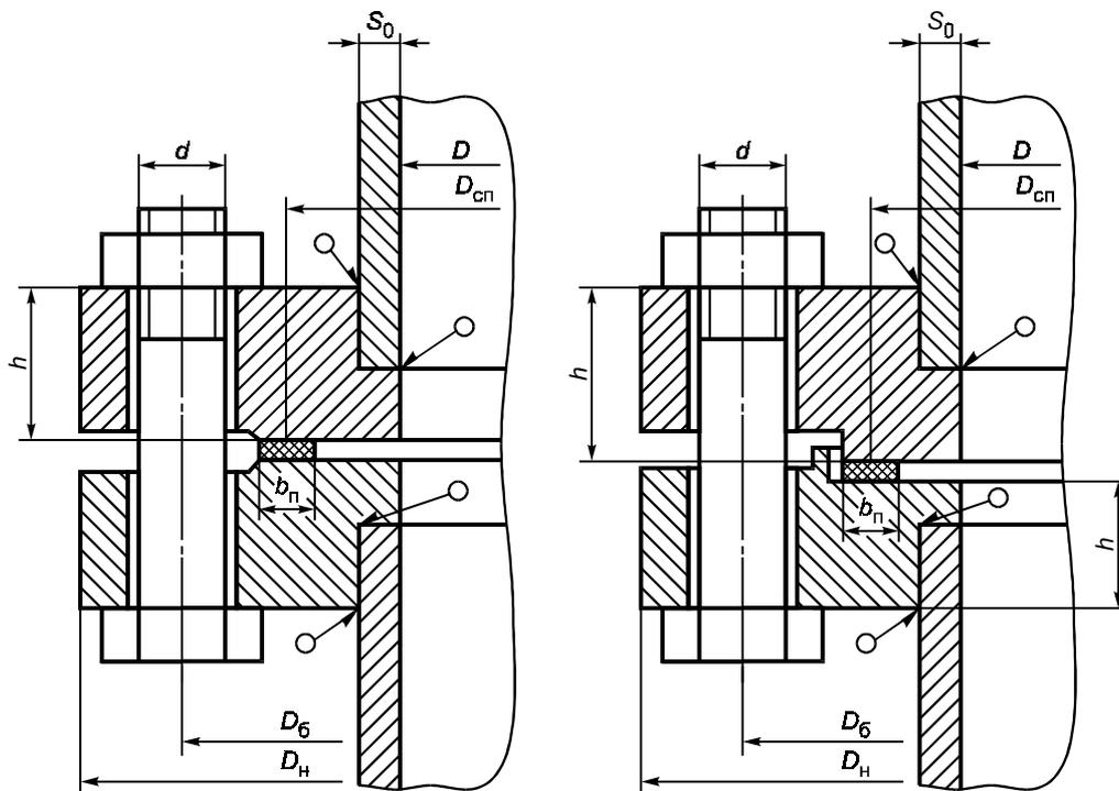
а — фланцевое соединение с гладкой уплотнительной поверхностью
