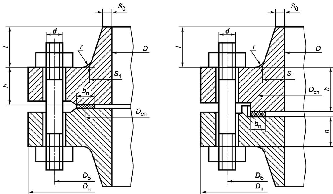
а — фланцевое соединение с гладкой уплотнительной поверхностью
