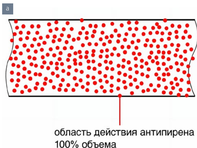
Рисунок 4. а — предполагаемая схема распределения модифицирующей добавки по поверхности филамента, б — фото, демонстрирующее морфологию поверхности филамента ПОД волокна с модифицирующей добавкой АП2
