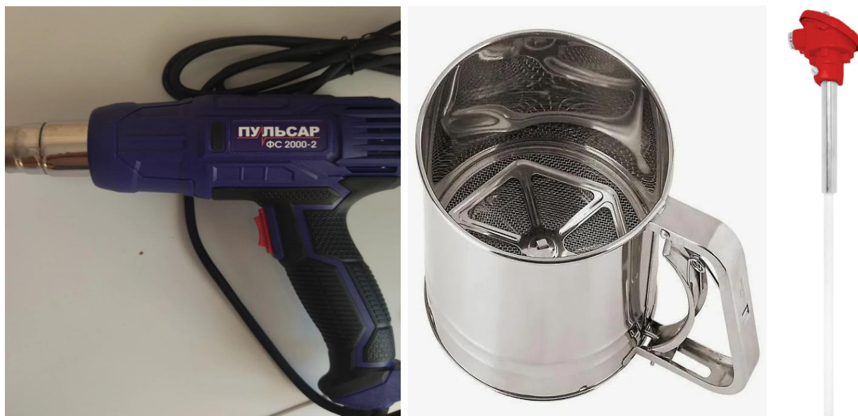
Рисунок 3.12 – Оборудование для проведения экспериментов по конвективной сушке слоя растительных отходов
