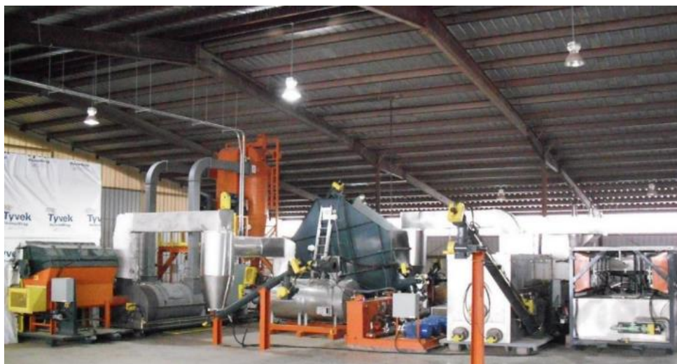
Рисунок 1.15 – Установка компании ABRI-Tech в стационарном исполнении (производительность 50 тонн в сутки)
