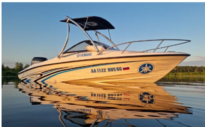
Рисунок 3. Корпус катера изготовлен из стеклопластика на основе материалов POLYSTAR
