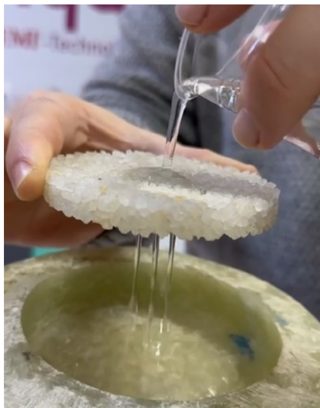
Композитный камень на основе минерального наполнителя и эпоксидной смолы
