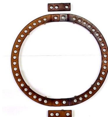
Рисунок 24. Элементы аппарата Иллизарова из отечественного ПФС
