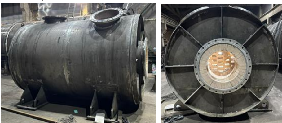
Рисунок 22. Топка нагрева газов для каталитического восстановления оксидов азота
