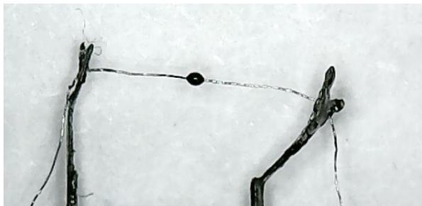
Рисунок 3.4 – Общий внешний вид бусинкового термистора типа СТ1-18
