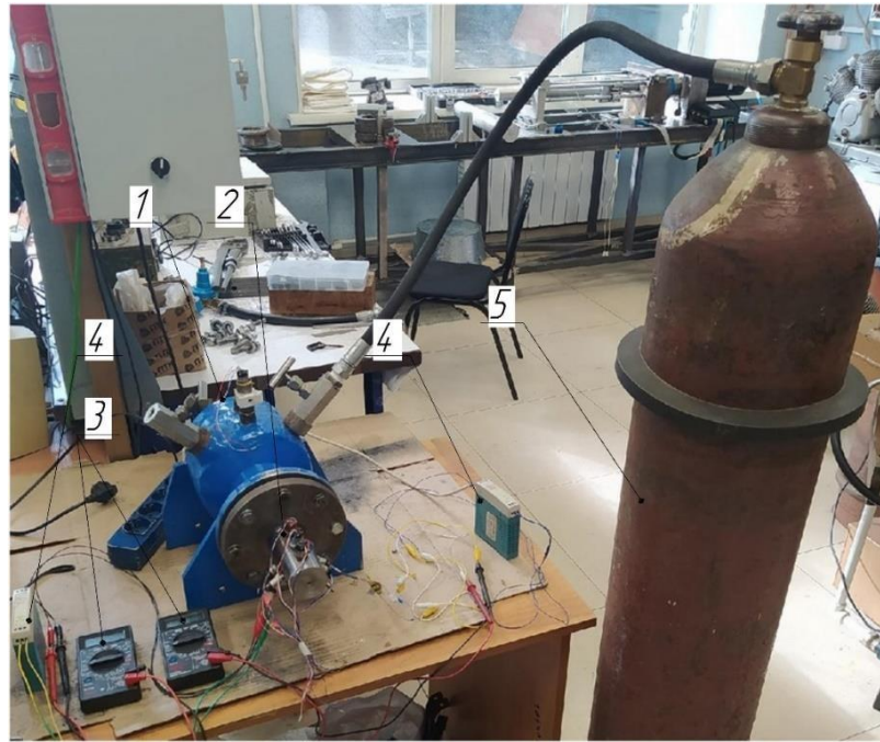
Рисунок 3.17 – Общий вид экспериментального стенда: 1 - ёмкость, 2- блок наборного поршня, 3- мультиметры, 4- блок питания, 5- баллон со сжатым воздухом
