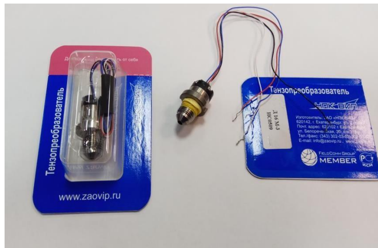
Рисунок 1.25 – Датчик давления серии D16-T
