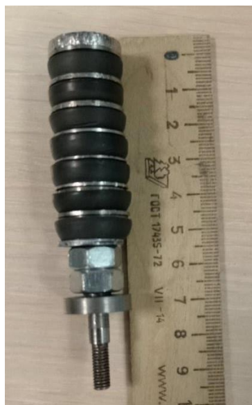
Рисунок 3.19 – Общий вид наборного поршня
