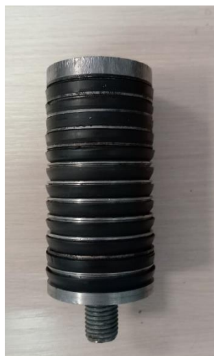
Рисунок 3.21 – Наборный манжетный поршень с 12-ю манжетными уплотнениями
