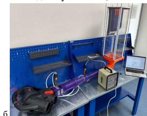
Рисунок 23 – Экспериментальная установка: а) принципиальная схема, б) фотография: 1 – корпус; 2 – сепаратор; 3 – вентилятор; 4 – фильтр тонкой очистки; 5 – дозатор
