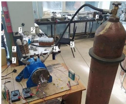
Рисунок 8 – Общий вид экспериментального стенда: 1 – рабочая камера, 2- блок наборного поршня, 3- мультиметры, 4- блок питания, 5- баллон со сжатым воздухом
