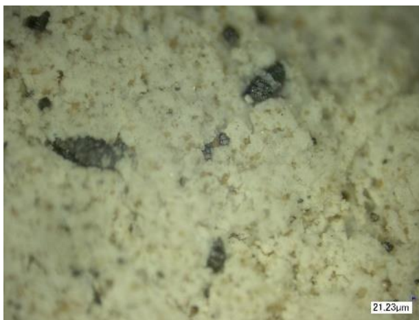
Рисунок 3.81 – Структура поверхности образца с содержанием ТРГ 1 мас. ч. и 30 мас. ч. гидроксида алюминия после горения (увеличение \times 100 )
