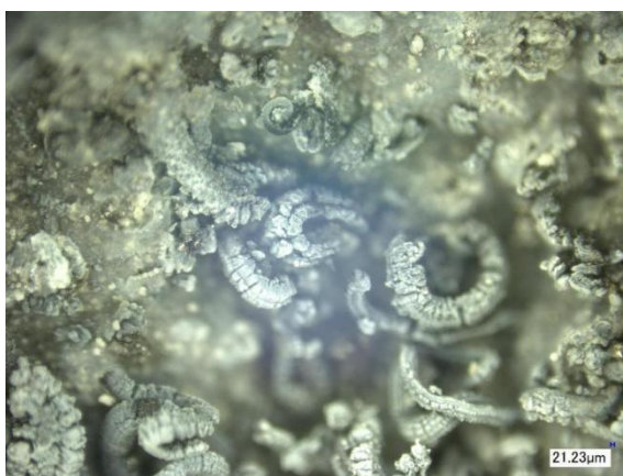
Рисунок 3.67 – Структура поверхности образца с содержанием ТРГ 15 мас. ч. после горения (увеличение \times 100 )
