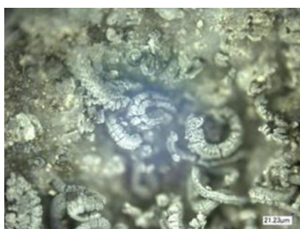
Рис. 7. Структура поверхности образца с содержанием ТРГ 15 мас. ч. после горения (увеличение \times 100 )
