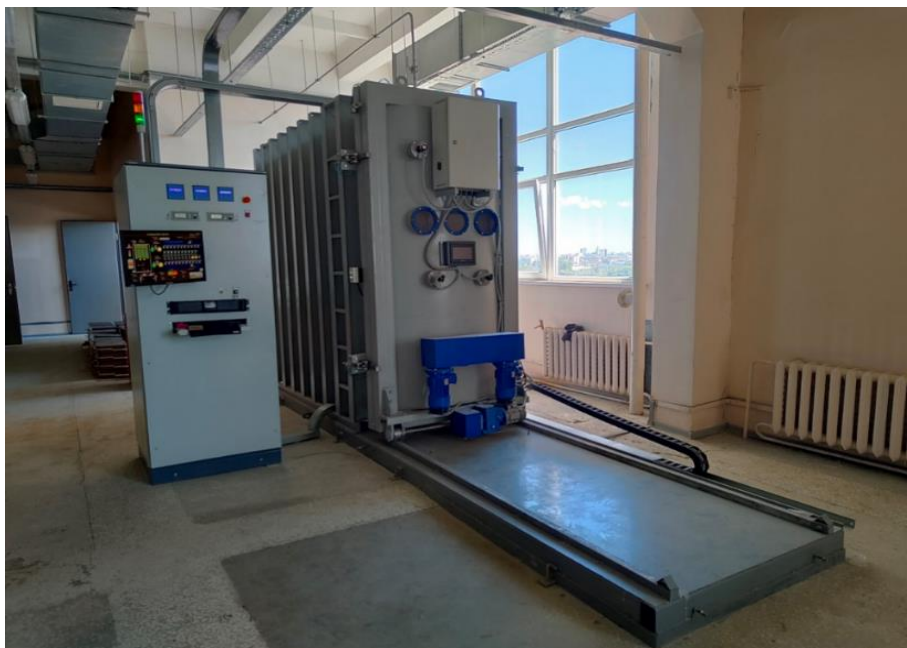
Рисунок 6.1 – ВЧЕ-плазменная установка для обеспечения воздействия ПНЭИ на тканые материалы
