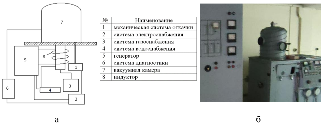
Рисунок 2.6 – ВЧИ-плазменная установка: а – функциональная схема установки; б – внешний вид ВЧ-плазменной установки в рабочем состоянии
