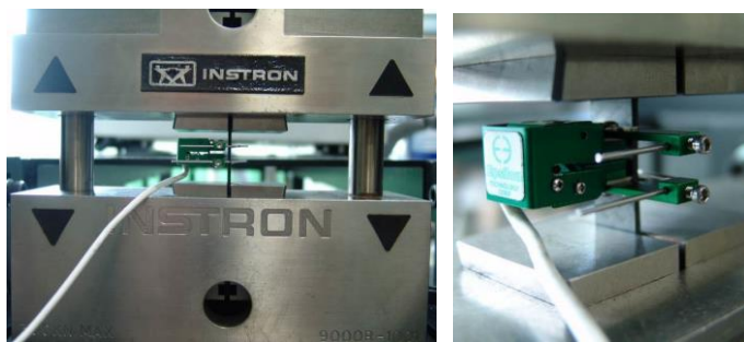
Рисунок 2.27 – Оснастка, используемая для определения продольного сжатия (а) и экстензометр с образцом при определении модуля упругости (б)
