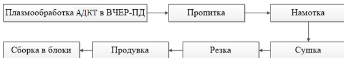
Рисунок 6.7 - Маршрутная схема техпроцесса изготовления ДК для ТМ с воздействием ПНЭИ на АДКТ
