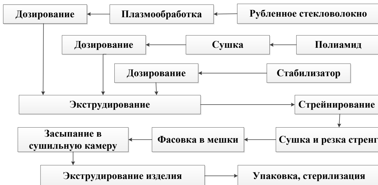
Рисунок 6.6 – Маршрутная схема техпроцесса получения ПКМ
