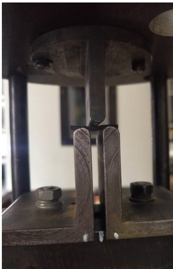
Рисунок 2.30 – Внешний вид специального приспособления для реализации способа «короткая балка»
