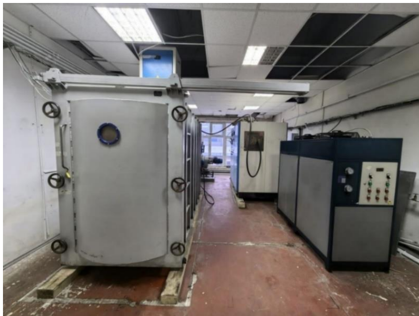
Рисунок 6.2 – Внешний вид ВЧЕ-плазменной установки для модификации армирующих волокнистых материалов ООО «Плазма-ВСТ»
