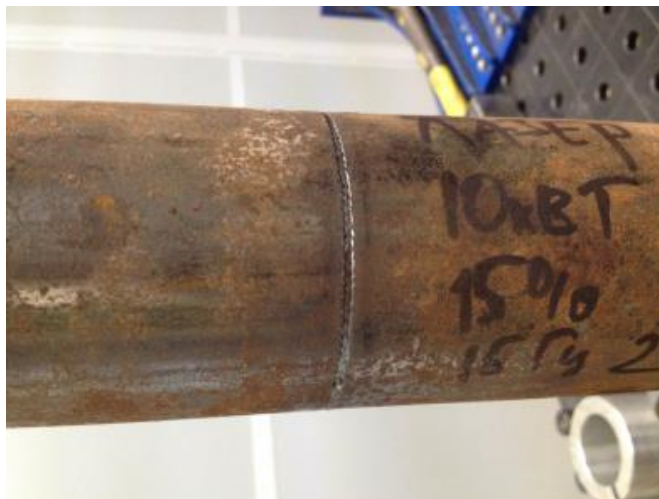
Рисунок 4.7 – Сварка трубы 09Г2С методом лазерной сварки в два прохода
