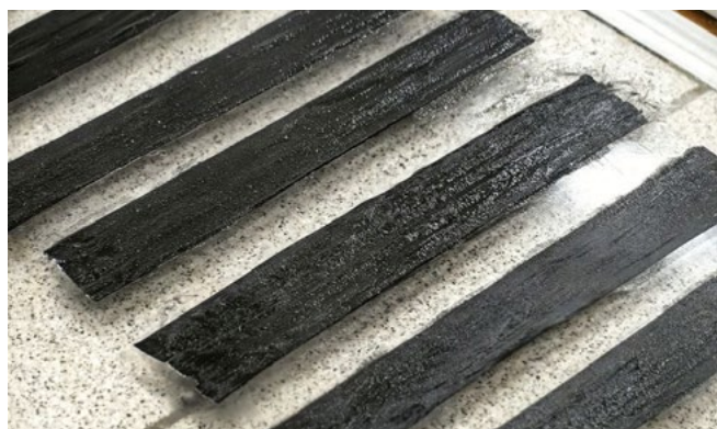
Рисунок 1. Внешний вид образцов однонаправленного углепластика, полученных методом ручного формования
