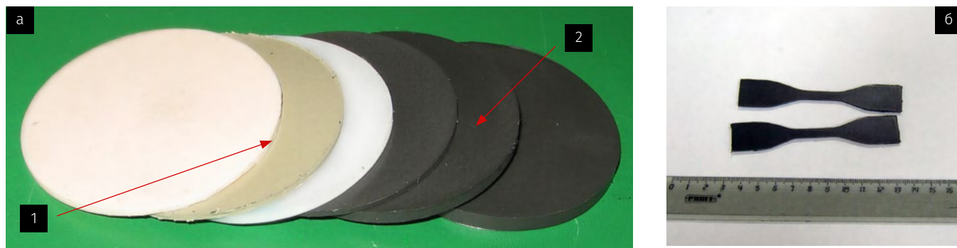
Рисунок 3. Фотографии испытательных дисковых (а) и разрывных (б) образцов из полимерного композита: 1 — из исходного СВМПЭ, 2 — из модифицированного карбидом бора и нановольфрамом
