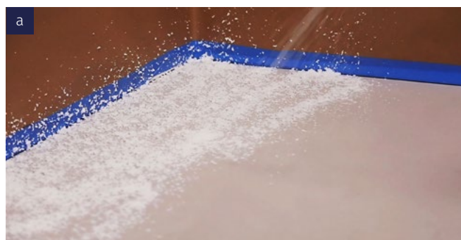
Рисунок 2. Нанесение клей-спрея на водной (а) и органической основе (б)
