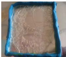
Рис.1 – Нитропленка из коллоксилина марки ПСВ
