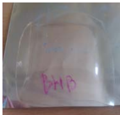
Рис.2 – Нитропленка из коллоксилина марки ВНВ
