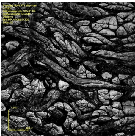
Рисунок 3.25 – Микроструктурное изображение поперечного среза а.о. из кожи (1) (табл.3.7) после трехфазной обработки (x20).
