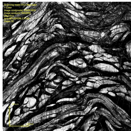
Рисунок 3.24 – Микроструктурное изображение поперечного среза а.о. из кожи после консервации акриловой смолой (x20)
