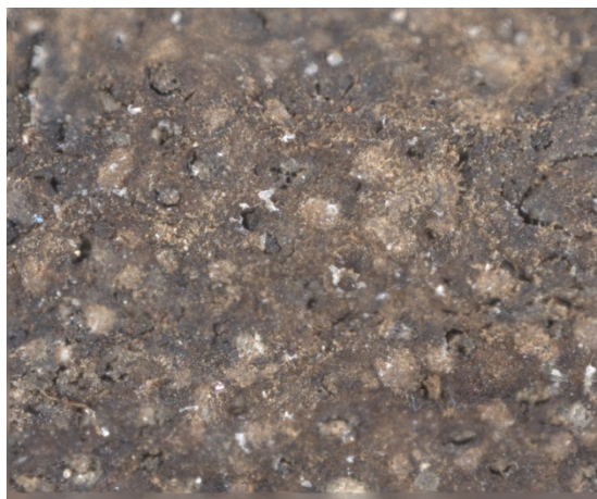
Рисунок 2.14 – Микроструктурное изображение поверхности лицевого слоя археологического образца XVIII в. (100 x )
