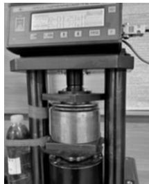
Рис. 10. Пресс-форма для изготовления контейнеров (а); биоразлагаемый контейнер (б)
