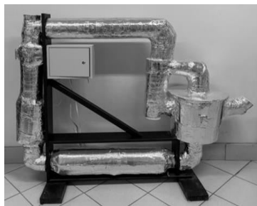
Рис. 3. Экспериментальная установка для озонирования древесного наполнителя: а) внешний вид; б) схема установки, где 1 – загрузочная воронка; 2 – камера; 3 – циклон; 4 – сборник; 5 – вентилятор; 6 – озоногенератор; 7 – нагревательный узел; 8 – терморара; 9 – шибер; 10 – газоанализатор; 11 – панель управления
