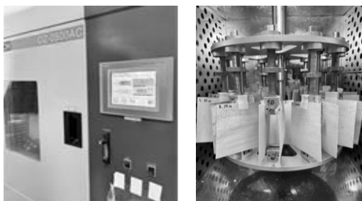
Рис. 1. Лабораторная камера OZ-0500AC (а); образцы шпона, закрепленные внутри камеры (б)
