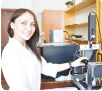
• Прибором для измерения краевого угла смачивания Kruss Easy Drop магистрантка второго курса Карина Ситдикова пользуется в научной работе постоянно.
