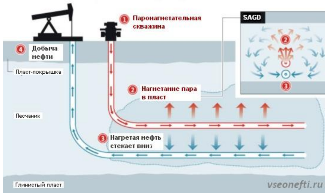
Рисунок 1.7-Парогравитационный дренаж (SAGD)
