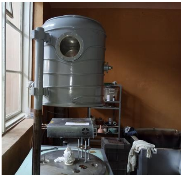
Рисунок 2.1 - Опытная ВЧ-плазменная установка, работающая в диапазоне P=13,3-133 Па
