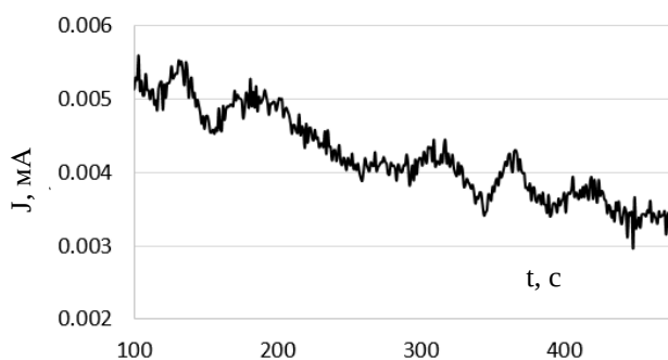
Рисунок 3.22 – Хроноамперограмма при \Delta E = 50 мВ (образец стали 12Х18Н10Т в растворе 0,5 М NaCl)
