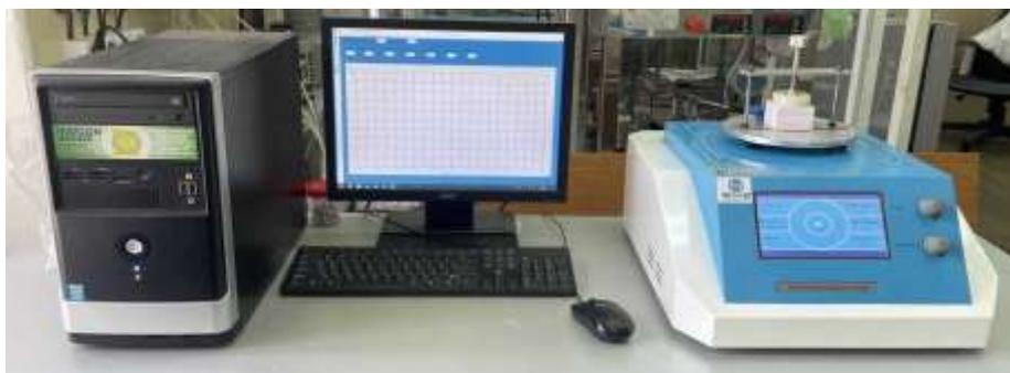
Рисунок 2.6 – Внешний вид установки по измерению коэффициентов теплопроводности
