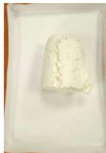
Рисунок 4.45 – СЭМ изображение и внешний вида полученных в результате диспергирования образцов полимерной смеси ПП 01030 (75%)/СКЭПТ 50 (25%) при  $T=333$  К и  $P=15$  МПа (условия №6 табл. №3)
