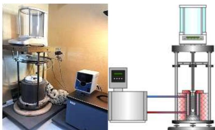
Рисунок 2.9 – Фотография гидростатического весового денситометра (ГВД, слева) и принципиальная схема (справа)
