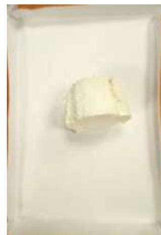
Рисунок 4.44 – СЭМ изображение и внешний вида полученных в результате диспергирования образцов полимерной смеси ПП 01030 (75%)/СКЭПТ 50 (25%) при  $T=313$  К и  $P=25$  МПа (условия №5 табл. №3)
