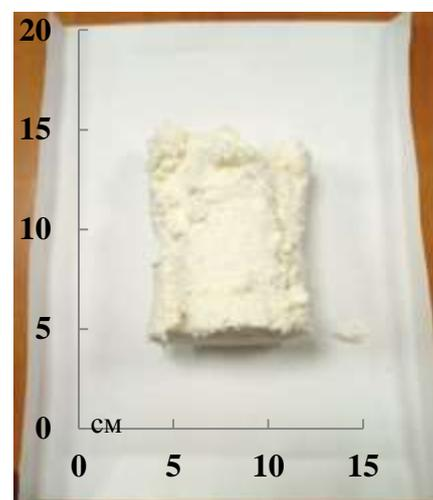
Рисунок 4.37 – СЭМ изображение и внешний вида смеси ПЭНД(75%)/СКЭПТ 50(25%), полученных в результате диспергирования, осуществленного при  $T=313$  К и  $P=25$  МПа
