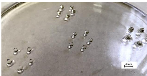
Рисунок 5.5 – Гелевые сферы АЛГ–ХТЗ, полученные способом 2
