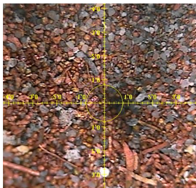
Рисунок 23 - Металлическая медь, полученная после выщелачивания шлака бронзы серной кислотой без перекиси водорода (Бронза -211)
